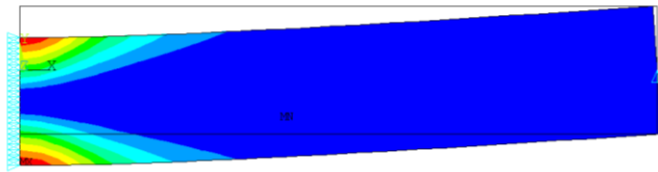
Zredukowane odkształcenia plastyczne (100% obciążenia)
